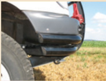
Le haut du bouclier a été récupéré pour parfaire la finition du pare-chocs tubulaire.
