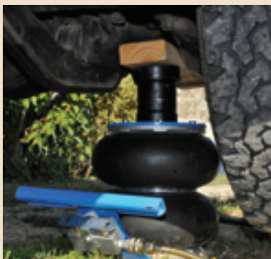
Le cric air fonctionne grâce au compresseur embarqué.
