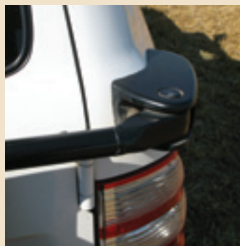
La fixation du compas de roue de secours sert aussi de marche pour accéder au toit.
