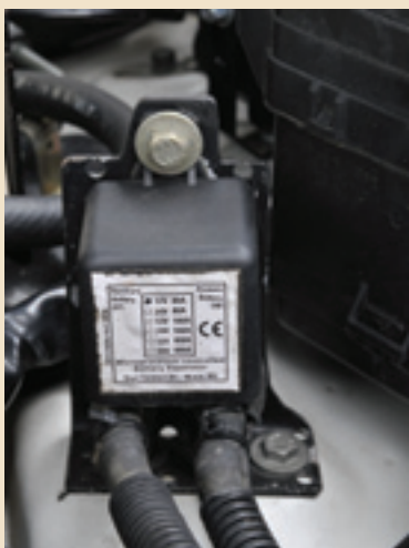
Le régulateur de charge est destiné aux batteries auxiliaires.
