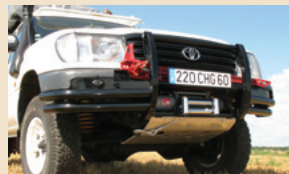
Le pare-chocs avant permet l'installation du blindage, du treuil et du cric Hi-Lift.
