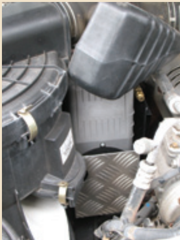
Le compresseur EMS et sa tôle de protection pare-chaaleur.
