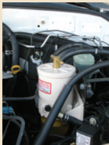
Indispensable à tout voyageur, le préfiltre centrifugeur Racor FG 500.
