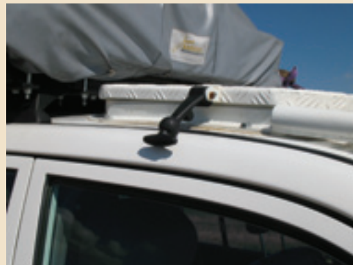
Des attaches-capot permettent de verrouiller l'écoutille.
