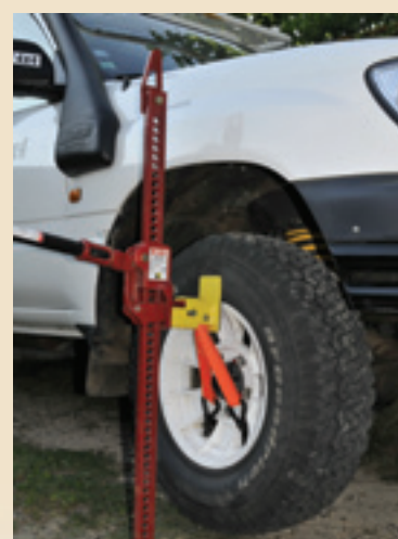
Système de levage bien pratique pour placer une plaque sous le pneu.
