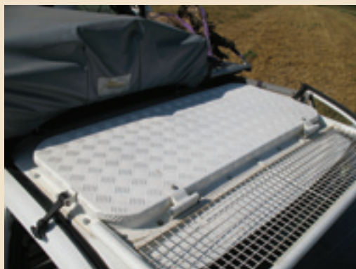
L'écoutille est une fort belle réalisation en alu damier.
